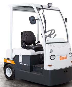
Trattore a 3 ruote, uomo a bordo, con trazione posteriore. Estremamente compatto e maneggevole, ideale per tutti i servizi industriali – sia all'interno che all'esterno.
