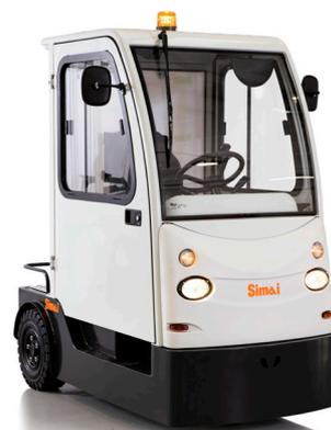
Trattore a 3 ruote, uomo a bordo, con trazione posteriore. Estremamente maneggevole, ideale per servizi intensivi sia all'interno che all'esterno. "AGV ready"
