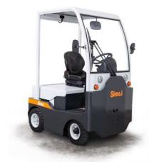
Trattore a 4 ruote, uomo a bordo, con trazione posteriore. Estremamente compatto e maneggevole, ideale per tutti i servizi - sia all'interno che all'esterno, anche per lunghi percorsi.
